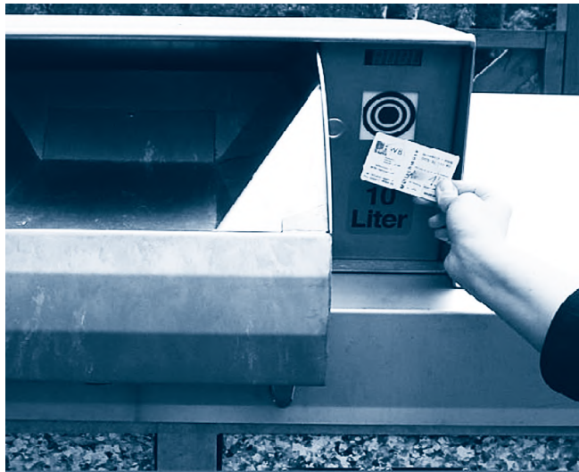
Figura 14. Contenidors de fracció resta amb control d'entrada del municipi de Schwerin (Alemanya).
