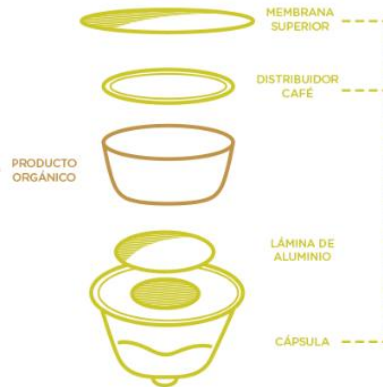
Figura 4. Components d'una càpsula de plàstic amb làmina d'alumini. Font: Ajuntament de Móstoles, 2022.
