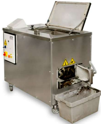
Figura 6. Màquina precompostadora electromagnètica utilitzada al projecte REVOLTA. Font: Tarpuna, 2016.
