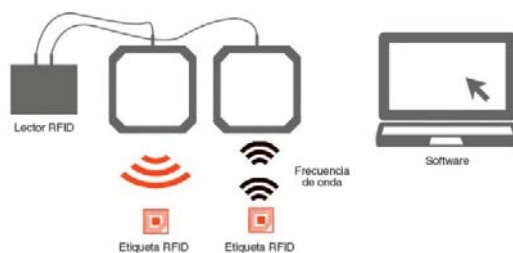
Figura 3. Esquema del funcionament del sistema RFID per l'obertura dels contenidors. Font: Consorci del Bages per la Gestió dels Residus, 2021.
