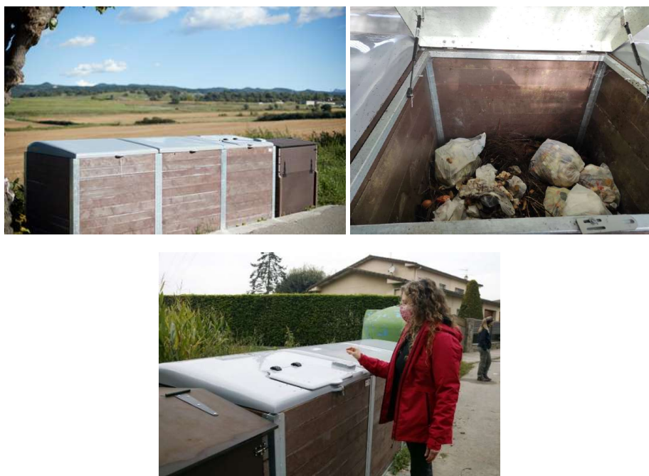
Figura 1. Punt de compostatge comunitari a Les Masies de Roda format per tres mòduls i un contenidor metàl·lic per les restes vegetals (superior esquerra), bosses dipositades a un dels mòduls (superior dreta) i mecanisme d'obertura (inferior). Font: Centre tecnològic BETA i https://www.lesmasiesderoda.cat .
