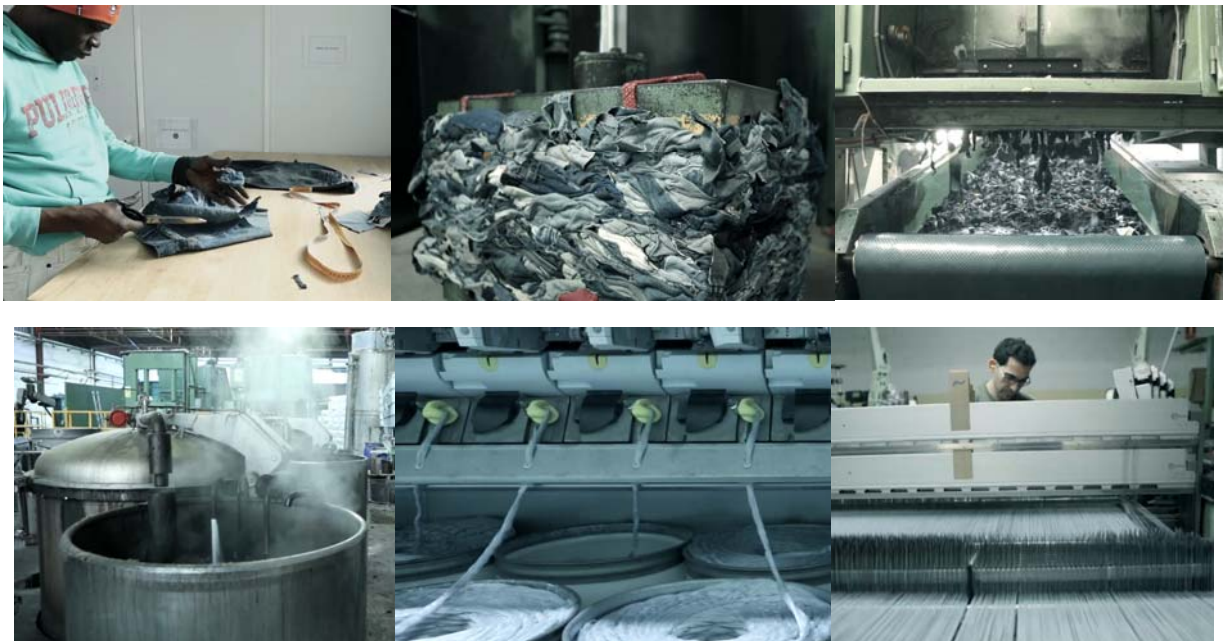
Figura 3. Etapes de producció del teixit Infinit Denim. D'esquerra a dreta: extracció de metalls (Barcelona), compactació dels texans (Sant Just Desvern), trituració del teixit (Olot), tinció de la Refibra (Ontinyent), filatura (Vic) i teixidura (Moià). Font: Canal de YouTube d'Infinit Denim.
