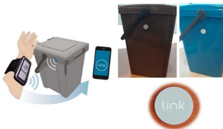
Figura 2. Dibuix esquemàtic de la tecnologia utilitzada pels operaris en la recollida porta a porta (esquerra) i detall del xip que incorporen els cubells per a la recollida de la fracció orgànica i multifracció (envasos lleugers i paper i cartró) (dreta). Font: Mancomunitat La Plana, 2018.
