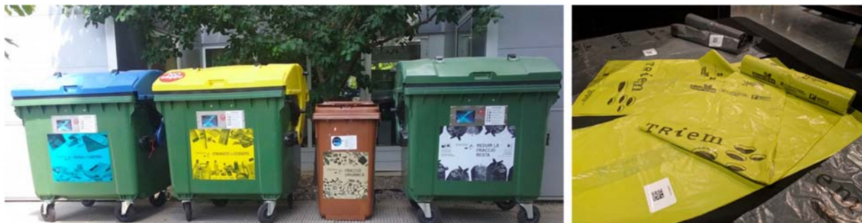
Figura 2. Illa de contenidors tancats amb accés controlat amb targeta identificativa (esquerra) i bossa d'envasos lleugers amb codi QR (dreta) Font: Consorci de Medi Ambient i Salut Pública, SIGMA, 2020.
