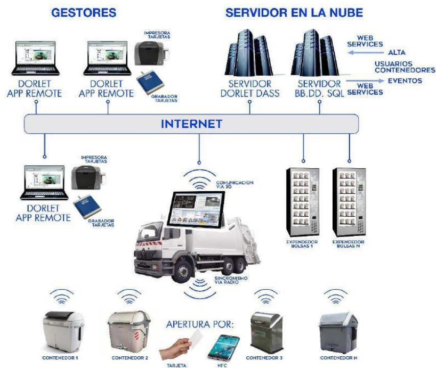
Figura 1. Esquema sobre el funcionament dels sistemes d'obertura mitjançant targeta magnètica en els contenidors de recollida de residus. Font: AGA - Dorlet, 2017.
