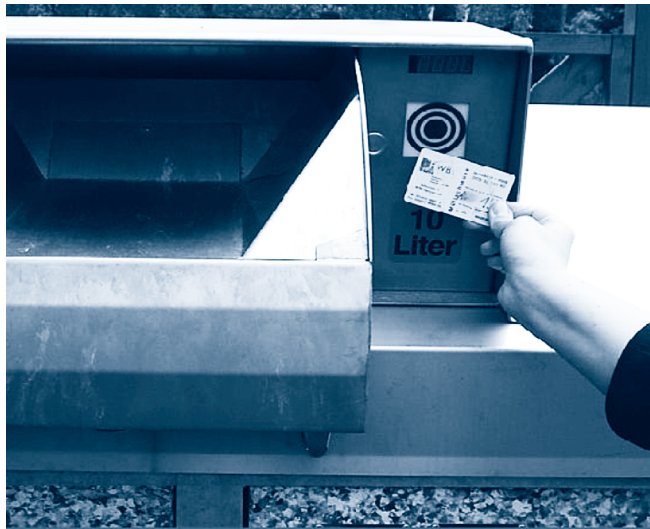
Figura 14. Contenedors de fracció resta amb control d'entrada del municipi de Schwerin (Alemanya).
